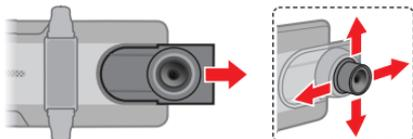
3. 透過 Type-C 充電線將主機連接至車上的點煙器電源插座，並妥善架設線組。為確保訊號良好及避免干擾駕駛者的視線及動作，架設線組時應注意線組的長度並固定其位置（例如繞過車子的擋風玻
