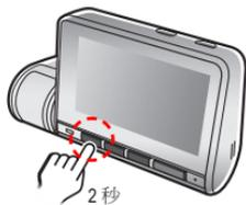
在少數的情況下，系統出現延遲或停滯的狀態時，您可能需要重置您的系統。利用細條狀物（如迴紋針）壓一下重置鍵即可重新啟動系統。
