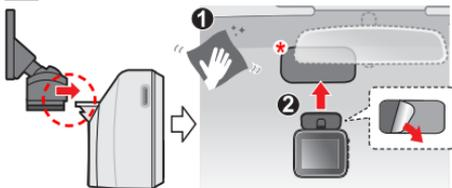
\* 先將靜電貼吸附在擋風玻璃，再將本裝置黏在靜電貼上，並注意其鏡頭未被靜電貼擋住以免影響錄影品質。如靜電貼無破損、凹折，可重複使用。
